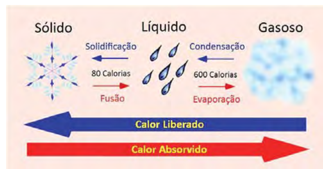
Fig. 3.2 Mudanças de estado físico da água pelo calor.
