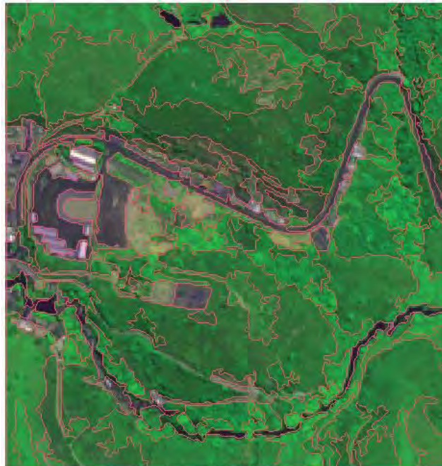
Fig. 13.1 Imagem segmentada com limiar de similaridade = 15 e área (pixels) = 50.
