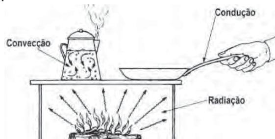
Fig.3.1 Processos de transferência de calor (fonte http://fisica.ufpr.br . acesso 2/10).
