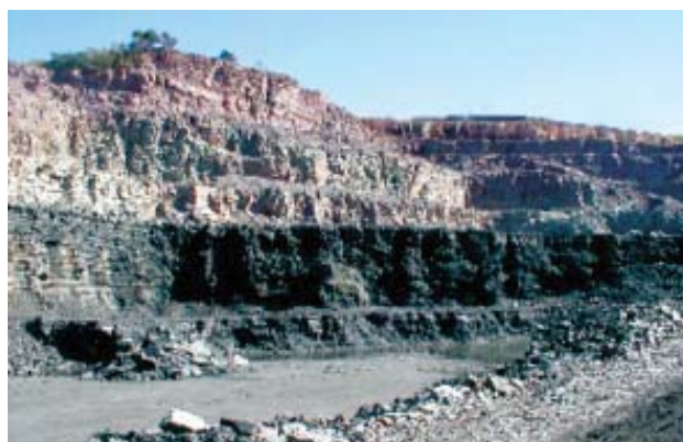
Figura 14.72 – A porção escura dessa frente de lava corresponde a uma camada de calcário dolomítico pertencente à Formação Irati, explorado para corretivo de solos. A parte superior mais clara representa sedimentos argilosos da Formação Corumbataí, explorados para fabricação de cerâmica (SP).
