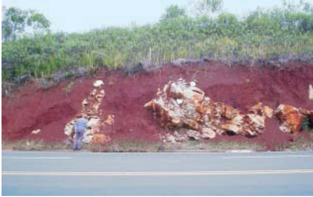
Figura 14.120 – Afloramento de rocha calcária isolado em meio a solos bem evoluídos é uma característica que complica sobremaneira a execução de escavações e obras subterrâneas em terrenos calcários, como nesse caso, relacionado ao Grupo Açungui (região metropolitana de Curitiba, PR).
