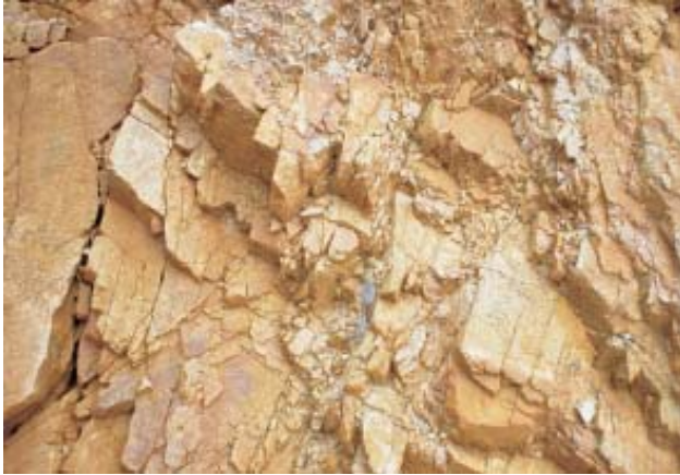
Figura 14.131 – Quartzito densamente fraturado em várias direções, o que o torna uma rocha de alta permeabilidade e porosidade secundárias (município de Castro, PR).
