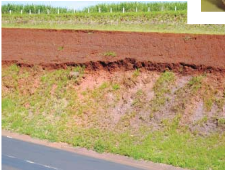
Figura 14.84 – Erosão diferencial em solo derivado de basalto. A parte inferior mais erosiva é sustentada por um solo pouco evoluído e portador de argilominerais expansivos – a variação dos estados de expansão e contração dos argilominerais expansivos faz com que o solo se desagregue em pequenas pastilhas que erodem como se fossem areias inconsolidadas. A parte superior, pouco erosiva, é sustentada por solo bem evoluído. Nesse caso, mantém boa estabilidade em taludes de corte (região de Fernandópolis, SP).
