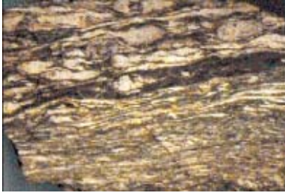
Figura 14.163 – Exemplar de granito pré-tectônico com a mineralogia fortemente e diferentemente deformada e estirada segundo uma direção preferencial. Isso é indicativo de que o granito se cristalizou ou se recrystalizou sob condições de elevadas temperaturas e pressões.
