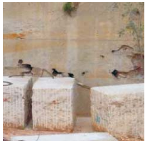
Figura 14.147 – Lavra de mármore comercialmente conhecido como “Bege Bahia”, resultante da descalcificação dos calcários do Grupo Bambuí, com posterior redeposição.
