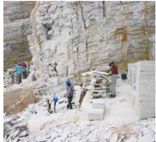
Figura 14.146 – Lavra de quartzito utilizado como pedra de revestimento (serra do Pico do Gavião, município de São Thomé das Letras, MG).
