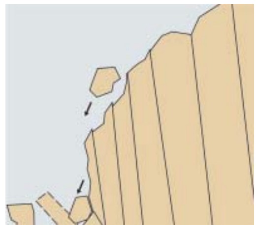
Figura 14.105 – Esquema mostrando o que acontece quando se fez um corte em posição concordante ao mergulho dos planos de fissilidade das rochas.
