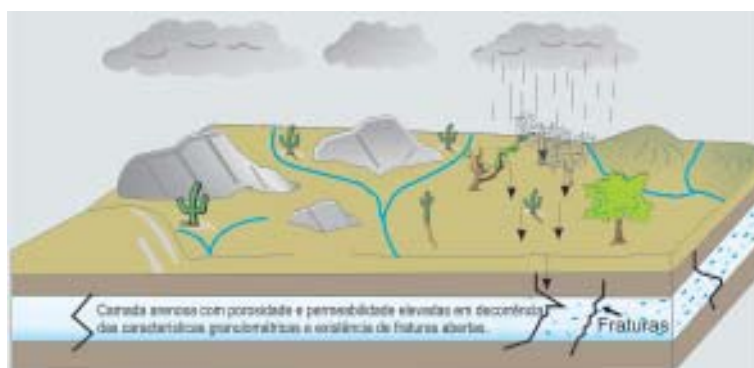
Figura 14.59 – Aquífero granular e fissural.
