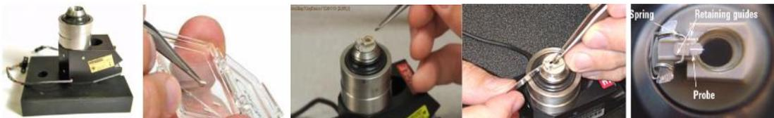
d) Colocar o cabeçote de volta no equipamento, conectar os cabos e prender com o parafuso
