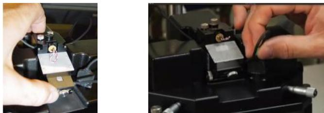
**NB.** O Ajuste do laser pode ser feita mediante a imagem da câmera, se uma amostra apropriada (refletora), como amostra padrão é utilizada.
