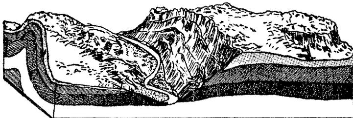
**Fig. 11M** — Seção transversal de um meandro, e embaixo meandro encaixado.
