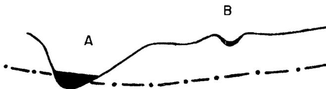
Fig. 14L — Influência do lençol de escoamento na concentração da drenagem lateral para o rio A.
